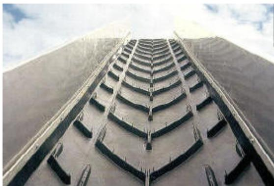
Шевронные конвейерные транспортерные ленты (Chevron) прочно зарекомендовали себя во многих отраслях промышленности - таких как горная, металлургическая, сельское хозяйство и др. Шевронные транспортерные ленты предназначены для наклонной транспортировки продуктов (угол наклона до 35°) в зависимости от высоты профиля. Более подробная информация по шевронным лентам представлена в таблице, расположенной ниже.
